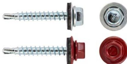
Стальные саморезы с шестигранной оцинкованной и цветной головкой со сверловидным наконечником, укомплектованные шайбой с резиновой прокладкой, для крепления кровельных материалов к деревянной обрешетке (диаметр самореза 4,8 мм) и к металлическим конструкциям (диаметр самореза 5,5 мм и 6,3 мм).
