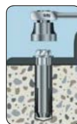
Затянуть болт или гайку с необходимым моментом
