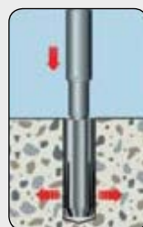
Выполнить анкерровку при помощи оправки
