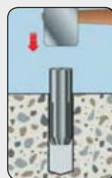
Установить анкер в отверстие
